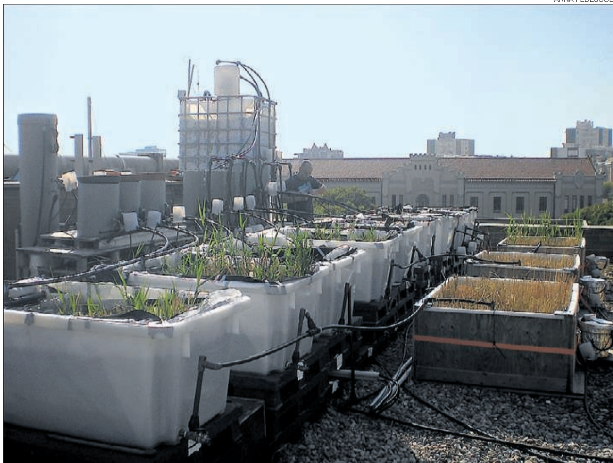
► Prototipos de humedales experimentales instalados en la UPC, en el campus norte de Barcelona.
